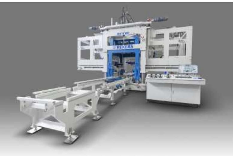
Ein besonderes Merkmal dieser Maschine ist, dass im Gegensatz zu herkömmlichen Maschinen kein Anheben des Vorsatzteils (ca. 7 Tonnen) erforderlich ist. Diese technologische Innovation führt zu
